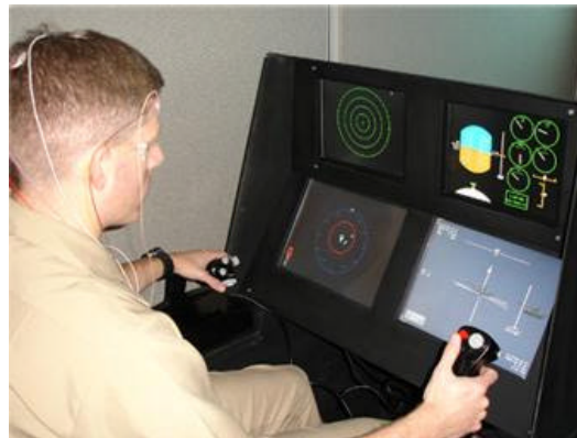
Figura 13. CogPit, un simulador de control de avión con cognición aumentada 14
